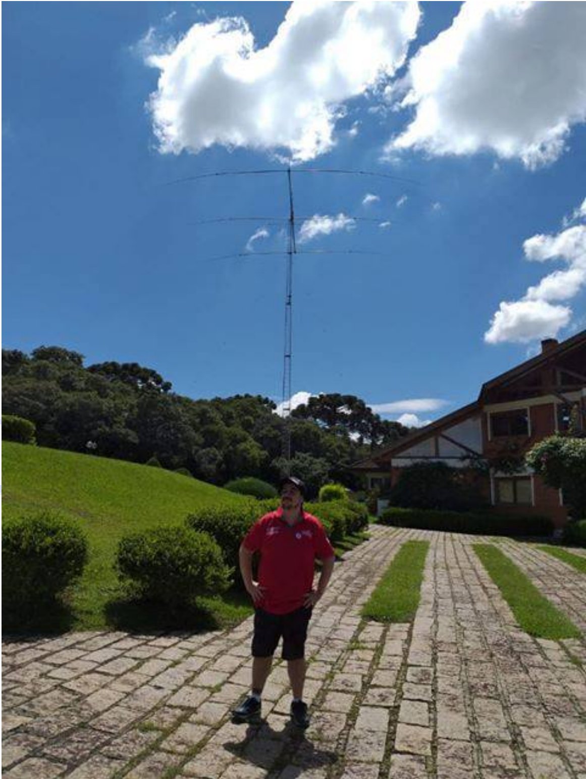
Imagem:: Martin Butera (PT2ZDX), ao lado da antena 3 elementos full size de 80 M
